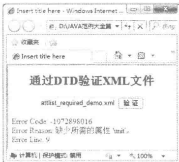
图 10.36 添加 #REQUIRED 参数后没有使用 unit 属性
