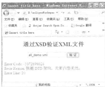
图 11.11 xs:all 声明的元素没有正确使用
